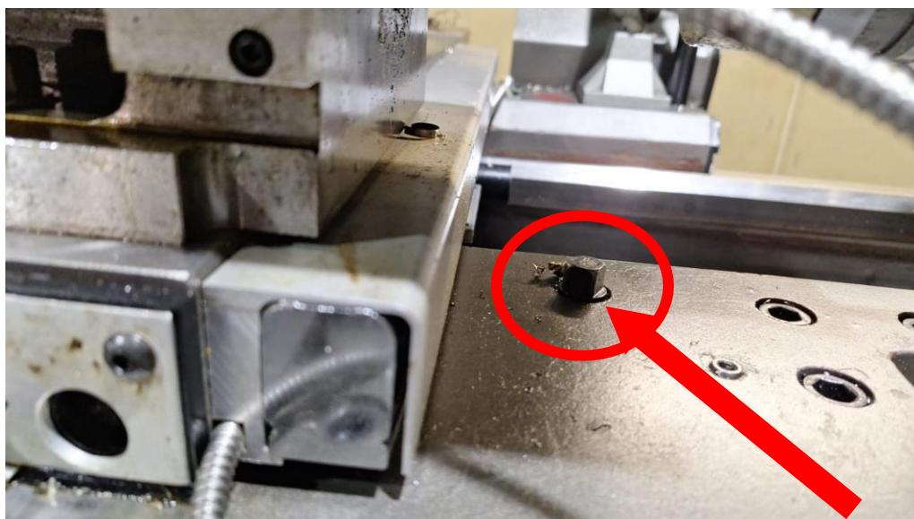
Установите уровень на нижнюю часть суппорта (на ползуне каретки). Как показано на рисунке и проверьте установку станка.
